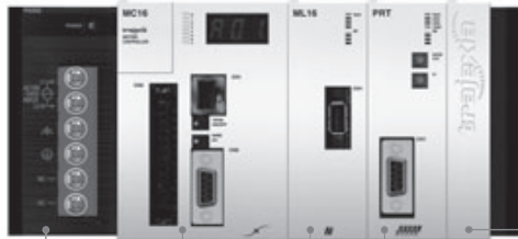
Alimentazione Unità controllo assi Controllo assi Comunicazione slave Coperchio terminale (incluso con la scheda controllo assi)
